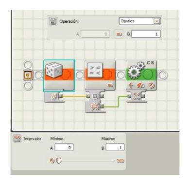
En la figura se puede ver en la parte superior el panel de configuración del bloque *Comparar*. Compara el número aleatorio con 1 con el operador *Iguales* de tal modo que convertirá el 1 en *Verdadero* (movimiento de avance) y el 0 en *Falso* (retroceso).
