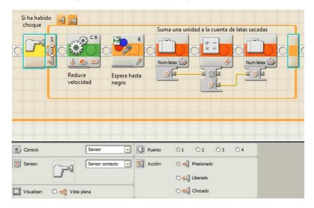
Tras detener el robot, retroceder y girar (paso 4) hay que comprobar cuántas latas están ya fuera. Para ello comprueba el valor del contador que en el caso de que sea 2 finaliza el bucle y genera un sonido antes de finalizar el programa (paso 5).
