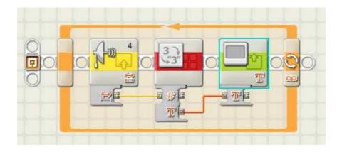
Los cables presentan diferentes colores en función del tipo de datos que transportan. El amarillo se corresponde a valores numéricos, el naranja a texto y el verde a valores lógicos. Si se realizan conexiones ilegales, las que unen conectores de diferentes tipos, el cable adquiere el aspecto de la siguiente figura. En dicho ejemplo se ha intentado unir una salida con valor numérico con una entrada que espera un texto.
