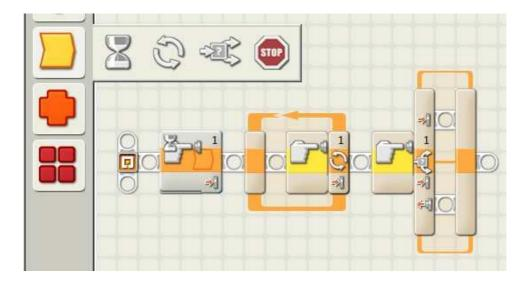
¡¡Atención!!: Una fuente de errores suele ser el confundir el uso del bloque que detiene el flujo del programa hasta que la lectura del sensor es la deseada (menú *Flujo* con franja naranja). y el que proporciona la lectura de un sensor (menú *Sensor*, con franja amarilla) En el segundo caso el programa lee la lectura del sensor y sigue adelante con el siguiente bloque. En la figura se puede apreciar la diferencia entre los dos en el caso del sensor de contacto.
