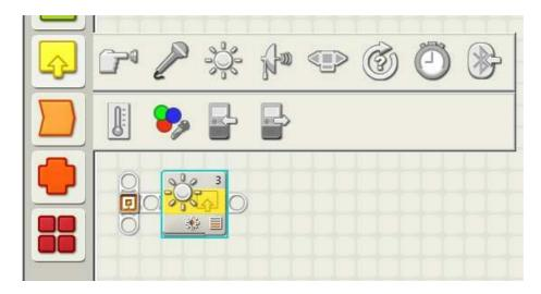
Además de este, se pueden utilizar las lecturas de los sensores ligadas a los bloques que controlan el flujo del programa: *Espera*, *Bucle* y *Bifurcación*, que pueden verse en la siguiente imagen asociados a un sensor de contacto.
