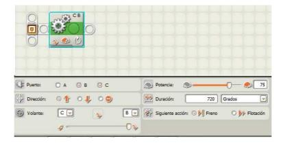
Tras varias pruebas he comprobado que con el valor de 500 el giro se acerca lo suficiente a 90°. Una vez que ya conocemos la magnitud del giro máximo será necesario generar dos valores aleatorios: uno para determinar el sentido de giro (0 ó 1) y el segundo para su magnitud (entre 0 y 500). En la siguiente figura puede verse el fragmento de programa correspondiente al giro.
