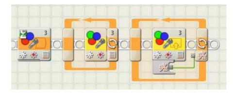
Dado que se tienen que repetir los mismos pasos una y otra vez habrá que colocar los bloques en el interior de un bucle tal y como se ve en la siguiente figura:
