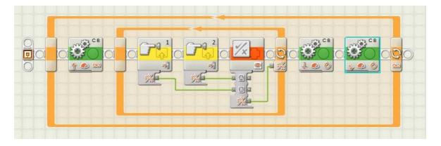
El robot se pone en marcha y lee continuamente los dos sensores, combina sus lecturas por medio de la función O y repite este proceso hasta que la función devuelve un Verdadero.
